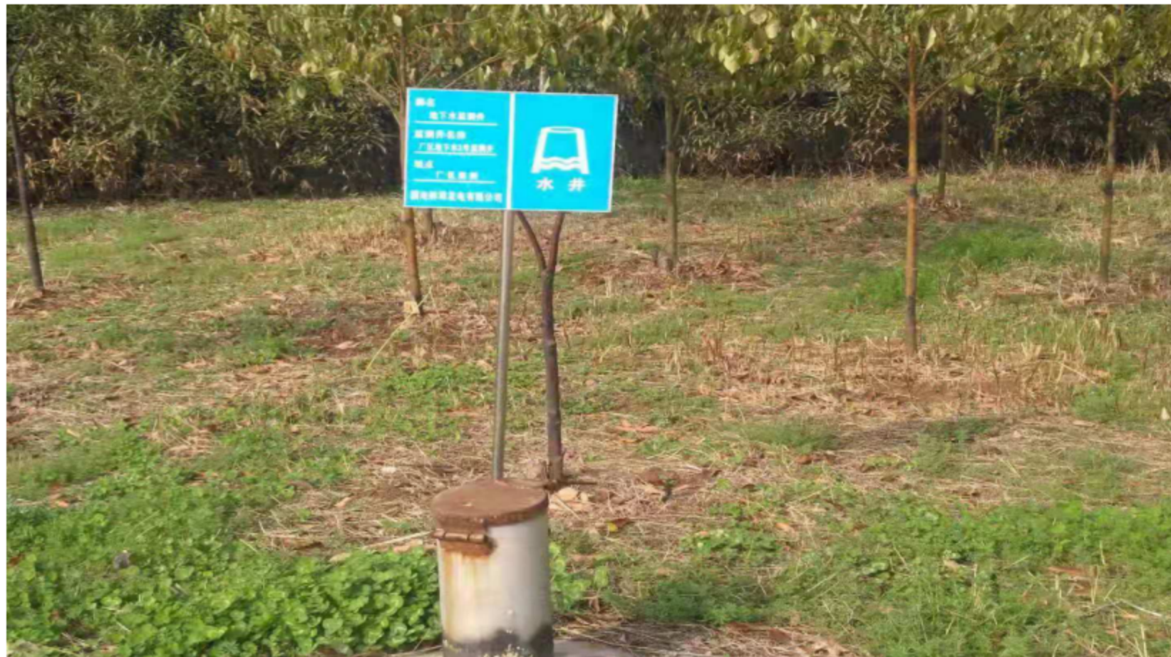
附件 13 厂区地下水监测井相关照片
